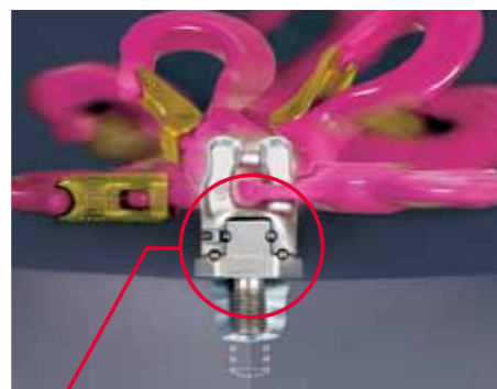
ダブルボールベアリング採用 負荷時でも360°スムーズに回転します。
